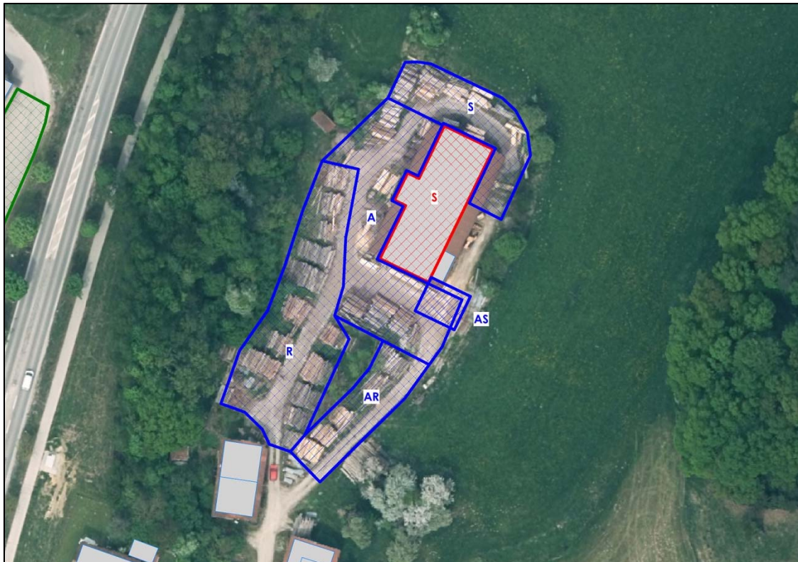
Abbildung 26: Luftbild mit Darstellung der relevanten Schallquellen des Sägewerks
